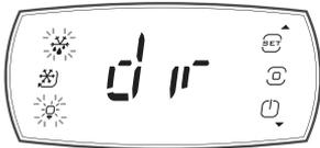
**Ergebnis:** Die Anzeige zeigt "dir". Die Tasten, die ständig leuchten, zeigen an, dass der entsprechende Antrieb/die entsprechende Funktion aktiv ist. Durch Tasten, die blinken, wird signalisiert, dass der entsprechende Antrieb/die entsprechende Funktion nicht aktiv ist.
