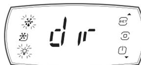
**Risultato:** Sul display viene visualizzato "dir". I pulsanti accesi indicano che l'attuatore/funzione corrispondente è attivo. I pulsanti lampeggianti indicano che l'attuatore/funzione non è attivo.
