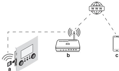
**В случае применения модуля беспроводной связи** требуются следующие компоненты:
