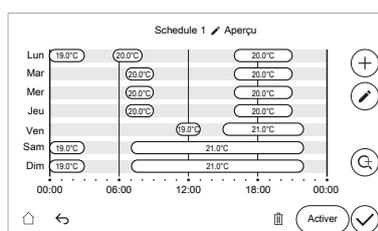
**Exigence préalable:** La programmation de la température intérieure est uniquement possible si le contrôle du thermostat d'ambiance est actif. Si le contrôle TD est actif, le programme s'applique plutôt à la TD.
