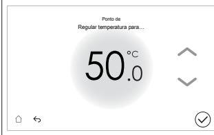
**Nota:** No modo Programação horária e reaquecimento, o Ponto de regulação reaquecimento é utilizado entre os aquecimentos programados (à temperatura definida na programação).
