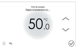
**Note :** En mode Horloge et réchauffement, le Point de consigne de réchauffement est utilisé entre les chauffages programmés (à la température définie dans la programmation).
