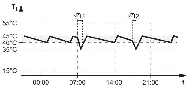
**T<sub>t</sub>** Temperatura del depósito de ACS
