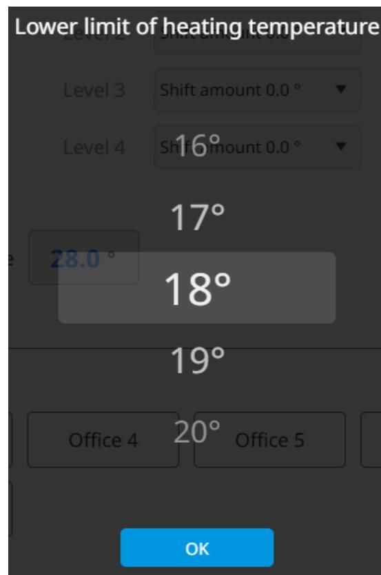
Quando si verifica uno scostamento della temperatura che potrebbe causare l'abbassamento del setpoint al di sotto del limite impostato, il setpoint rimane invece sul limite inferiore. Ad esempio, se in modalità di riscaldamento il setpoint è a 19°C e si applica uno scostamento di temperatura pari a 2°C quando il limite inferiore della temperatura per il riscaldamento è impostato a 18°C, il setpoint è modificato a 18°C (e non a 17°C).
