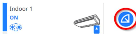
Se il controllo della domanda è abilitato, ma l'unità non è attualmente gestita dal controllo della domanda (il livello è a 0), l'icona non viene visualizzata nel riquadro dell'elenco delle apparecchiature. L'icona viene visualizzata solo quando il livello di limitazione del carico è 1 o superiore.
