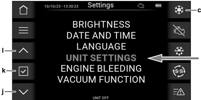
**Resultado:** Para poder aceder a "UNIT SETTINGS" [DEFINIÇÕES DA UNIDADE], a termostatização (c) deve estar desligada. Se a termostatização estiver ligada e o utilizador tentar entrar em "UNIT SETTINGS" [DEFINIÇÕES DA UNIDADE], a janela pop-up "Please, turn off thermoregulation before entering in Unit Settings." [Desligue a termostatização antes de entrar nas Definições da Unidade] (aa) é exibida.
