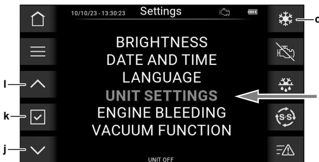
**Resultado:** Para poder acceder a "UNIT SETTINGS" [AJUSTES DE LA UNIDAD], la termostatación (c) debe estar DESACTIVADA. Si la termostatación está activada y el usuario intenta entrar en "UNIT SETTINGS" [AJUSTES DE LA UNIDAD], se muestra el mensaje emergente "Please, turn off thermoregulation before entering in Unit Settings" [Desactive la termostatación antes de entrar en los ajustes de la unidad] (aa).
