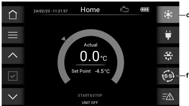
1 إذا كان وضع التنظيم الحراري (c) قيد التشغيل، أوقفه. لا يمكن تغيير اختيار وضع البدء والتوقف/الاستمرار أثناء تشغيل وضع التنظيم الحراري.
