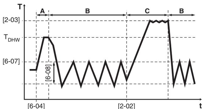
**A Funcionamiento de almacenamiento programado:** activado a [6-04], calentamiento de agua caliente sanitaria hasta que se alcance el punto de referencia de la interfaz de usuario del agua caliente sanitaria  $T_{DHW}$  (por ejemplo, 55°C).
