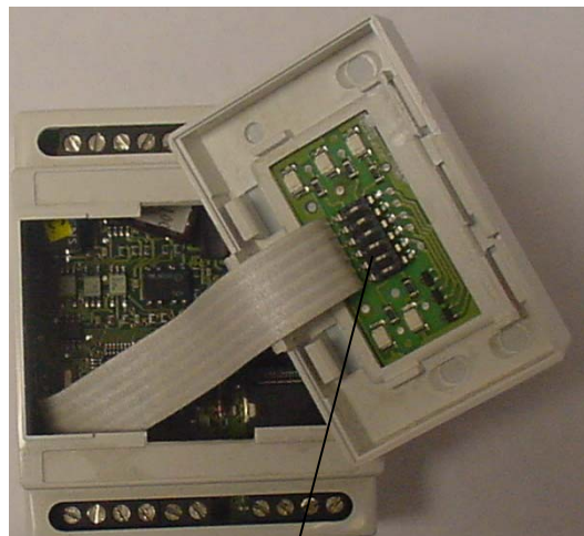
Рисунок 6. Внутреннее устройство привода
