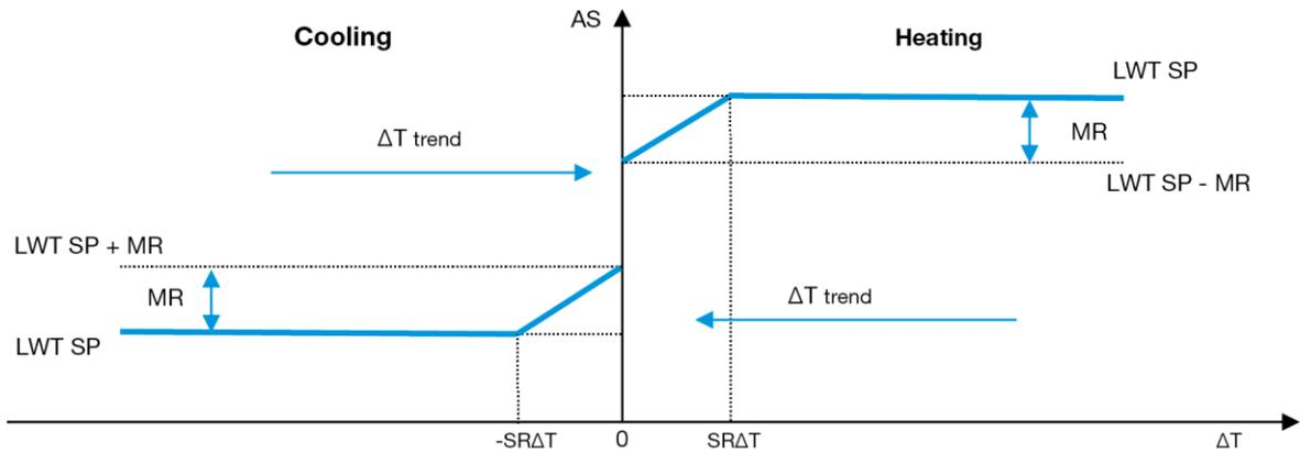
Gráfico 3- Evap  $\Delta T$  vs punto de ajuste activo - Modo frío (izquierda)/ Modo calor (derecha)
