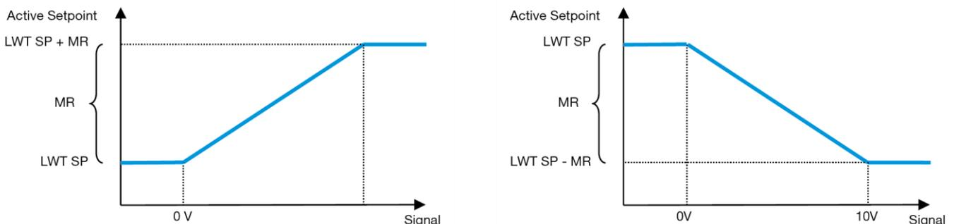
Gráfico 2 - Señal externa 0-10V vs punto de ajuste activo - Modo frío (izquierda) / Modo calor (derecha)
