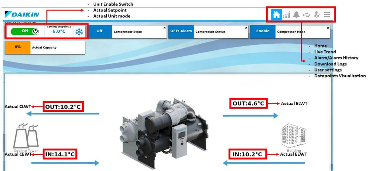
L'application OITS est définie pour échanger des données en temps réel avec le contrôleur MicroTech. Vérifier que le moniteur est connecté au PLC via un câble Ethernet afin que les données du PLC s'affichent correctement.
