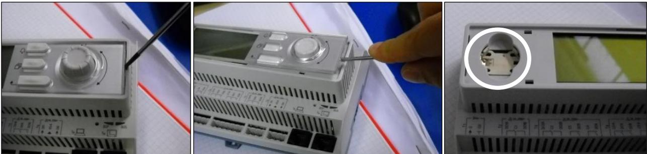
Veiller à ne pas endommager le couvercle. La nouvelle batterie peut être placée dans le support de batterie prévu à cet effet (surligné dans la photo ci-dessous) en respectant les polarités indiquées sur le support.
