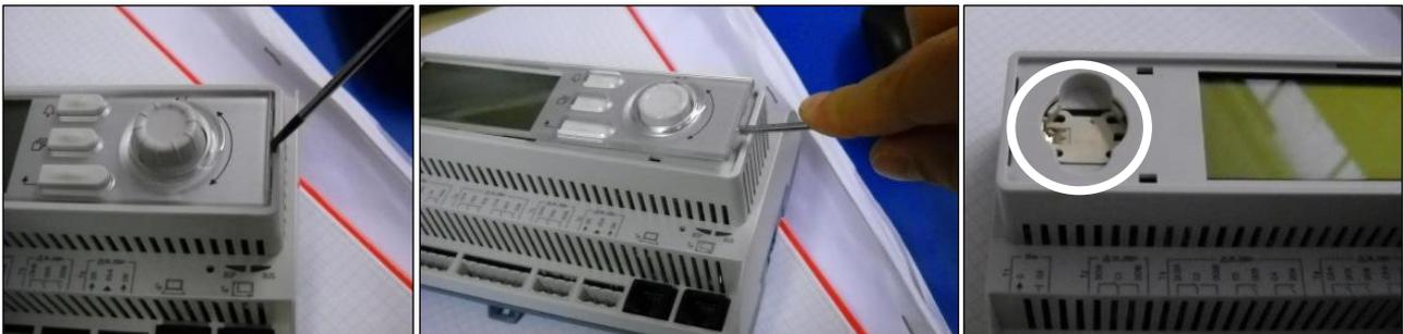
Seien Sie vorsichtig, damit die Kunststoffabdeckung nicht beschädigt wird. Dann die neue Batterie ordnungsgemäß in die Halterung - siehe den markierten Bereich im nachfolgenden Bild - einsetzen und dabei auf die richtige Polarität achten, so wie sie in der Halterung gekennzeichnet ist.
