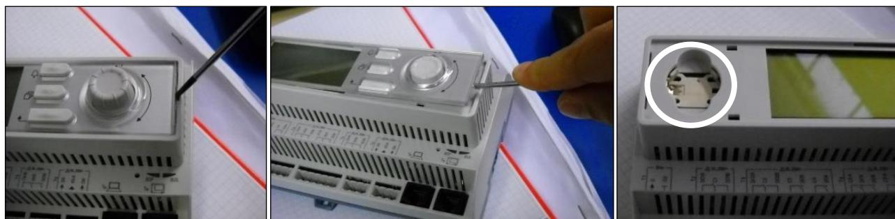
Pazite da ne oštetite plastični poklopac. Nova baterija mora se staviti u odgovarajući držač baterije koji je istaknut na sljedećoj slici, poštujući polaritete navedene u samom držaču.
