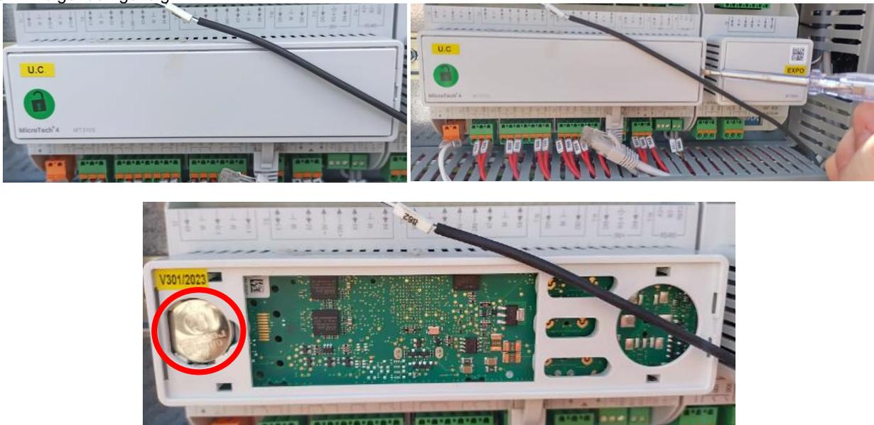
Achten Sie darauf, dass die Kunststoffabdeckung nicht beschädigt wird. Die neue Batterie muss in den richtigen Batteriehalter gelegt werden, der auf dem Bild hervorgehoben ist, wobei die in den Halter selbst angegebenen Polaritäten zu beachten sind.
