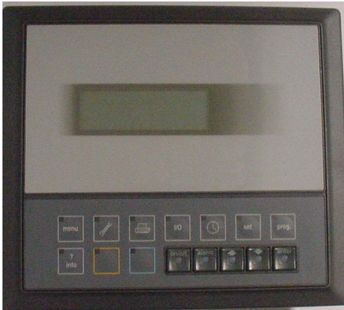
Figura 5 – Panel del controlador
