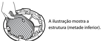
**3. Instale novos filtros de humificação em cada estrutura. (Ambos os filtros de humificação têm frente e verso.)**
