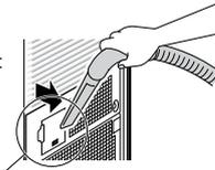
Entrée d'air pour le capteur
