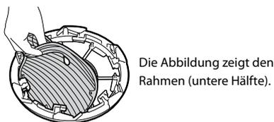
**3. Bringen Sie neue Befeuchtungsfilter an jedem Rahmen an. (Beide Befeuchtungsfilter haben eine Vorder- und Rückseite.)**
