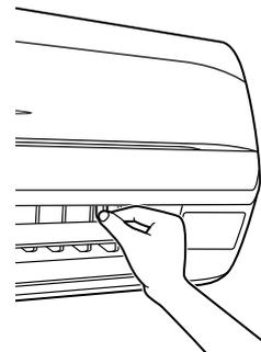
Stoppen Sie die horizontalen Schwenklappen in einer Position, in der Sie die Laschen greifen und nach links oder rechts verschieben können.
