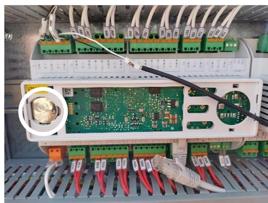
Fare attenzione a non danneggiare la copertura in plastica. Installare la nuova batteria nell'apposito alloggiamento, evidenziato nella figura, prestando attenzione alla polarità indicata nell'alloggiamento stesso.
