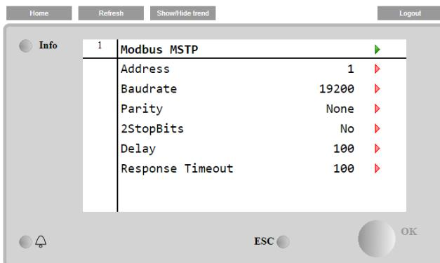
Για τη δημιουργία της σύνδεσης, η θύρα RS485 που θα χρησιμοποιηθεί είναι αυτή που βρίσκεται στο τερματικό T14 του ελεγκτή MT4.
