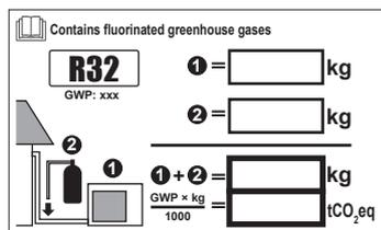
Carga total = Carga de fábrica ①<sup>(a)</sup> + carga adicional ②<sup>(b)</sup>
