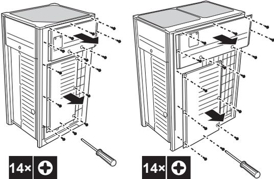
Una vez que las placas delanteras estén abiertas, se puede acceder a la caja de conexiones. Consulte "14.2.2 Apertura de la caja de conexiones de la unidad exterior" [p. 26].
