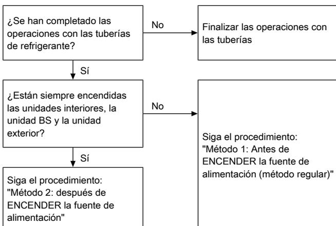
Es de vital importancia que las operaciones con las tuberías de refrigerante se realicen antes de encender las unidades (unidad exterior, unidad BS o unidad interior). Al encender las unidades, se activarán las válvulas de expansión. Esto significa que las válvulas se cerrarán.
