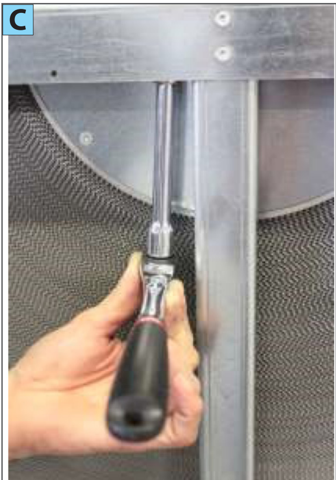
1) Χαλαρώστε τις 2 βίδες (εικ. C)
