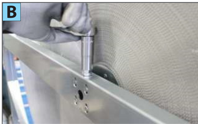
2) Ρυθμίστε τη σύγκλιση του τροχού χρησιμοποιώντας ένα κάθετο μπουλόνι (εικ. B).
