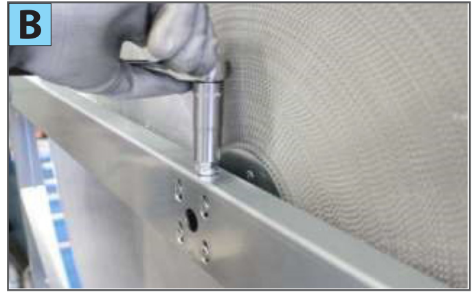
2) Die Konvergenz des Rads mit Hilfe des vertikalen Schraubenbolzens einstellen (Foto B)
