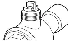
Ergebnis: Das Ventil ist vollständig geschlossen:
