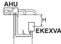
AHU Unità per il trattamento dell'aria
