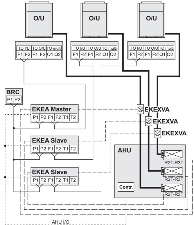
Per il circuito del refrigerante combinato, allo stesso circuito del refrigerante possono essere collegate una o più unità esterne.
