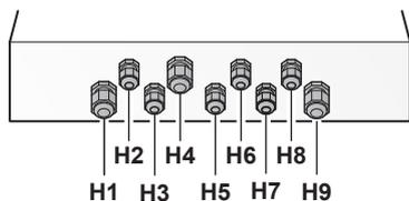
**H1~H9** Aperture per cavi/pressacavi. Se non sono in uso, chiudere con fermi (in dotazione come accessorio). H5 è utilizzato se viene implementata la funzione master-slave. Vedere "11.9 Configurazione master-slave" [p. 16].
