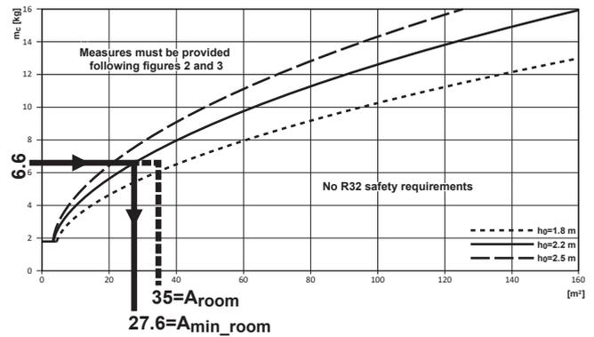
In base alla figura 1, non sono necessarie misure di sicurezza per l'R32 ( $A_{room} > A_{min\_room}$ ).
