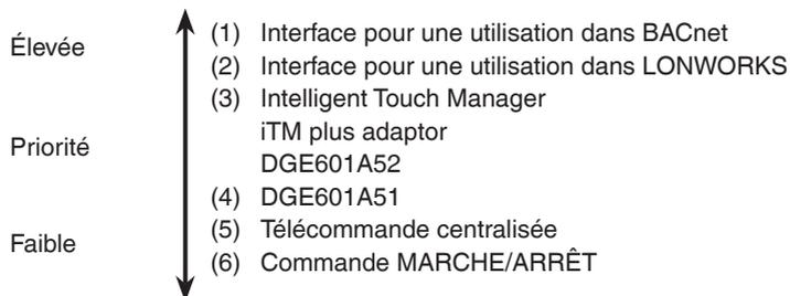
Les dispositifs de commande centralisés qui ne peuvent être raccordés au même réseau que le DGE601A52:
