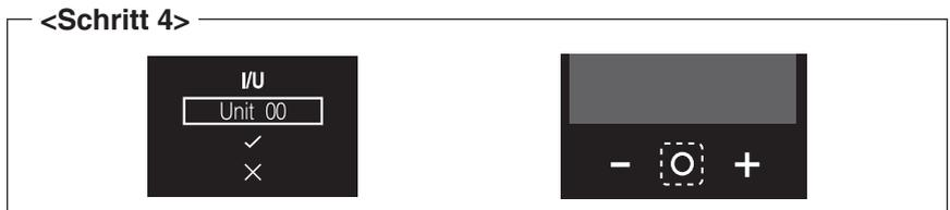
5. Verwenden Sie die Tasten **-** und **+** und wählen die Einheitennummer aus, die Sie einstellen möchten.
