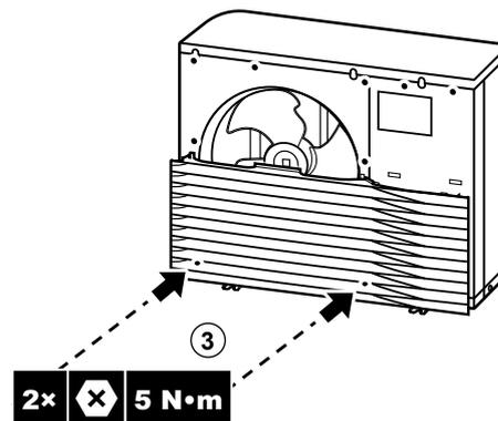
Installare la parte superiore della griglia di scarico
