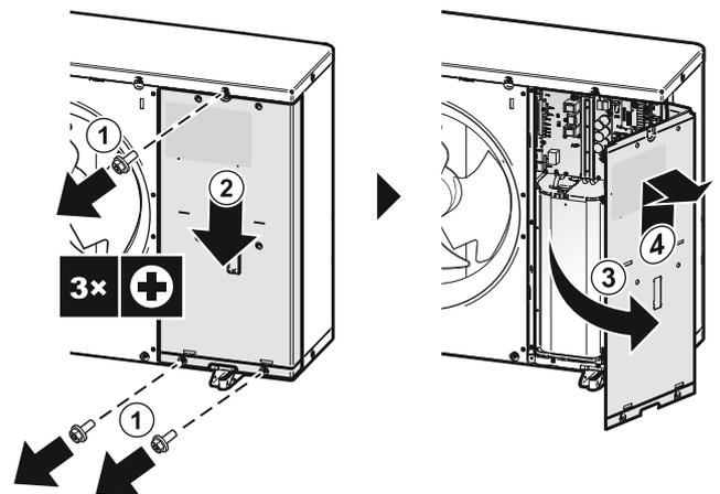
2 Se necessario, aprire il coperchio laterale. Tale operazione è necessaria, per esempio, nei casi seguenti:
