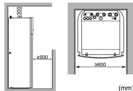
Adicionalmente às recomendações de espaçamento: devido à carga total de refrigerante no sistema ser  $\geq 1,84$  kg, a divisão na qual instalar a unidade de interior deve cumprir as condições descritas em "4.1.3 Padrões de instalação" [p. 7].
