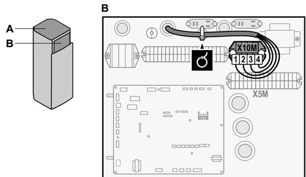
4 Fixe os cabos com as abraçadeiras nos apoios das abraçadeiras. Se necessário, junte o comprimento do cabo excessivo com uma abraçadeira.
