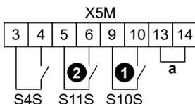
a Jumper (instalado de fábrica). Se também ligar um termóstato de segurança (Q4L), substitua o jumper pelos fios do termóstato de segurança.
