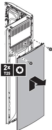
5 Se precisar de aceder aos componentes de alta tensão, retire a tampa da caixa de distribuição de alta tensão.
