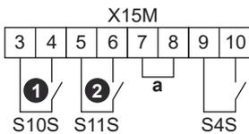
a Jumper (instalado de fábrica). Se também ligar um termóstato de segurança (Q4L), substitua o jumper pelos fios do termóstato de segurança.
