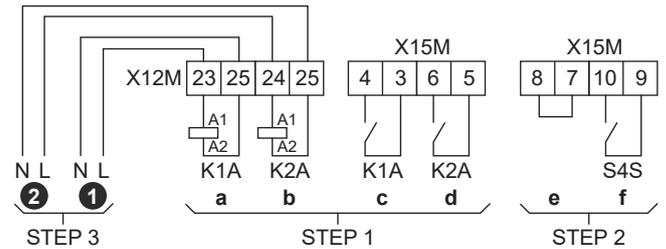
STEP 1 Instalação do kit de relé Smart Grid
