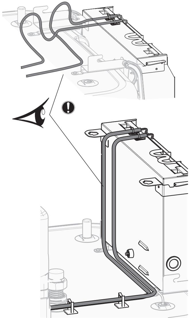
Todos os cabos que serão ligados à caixa de distribuição do ECH<sub>2</sub>O têm de ser fixados por alívio da tensão.
