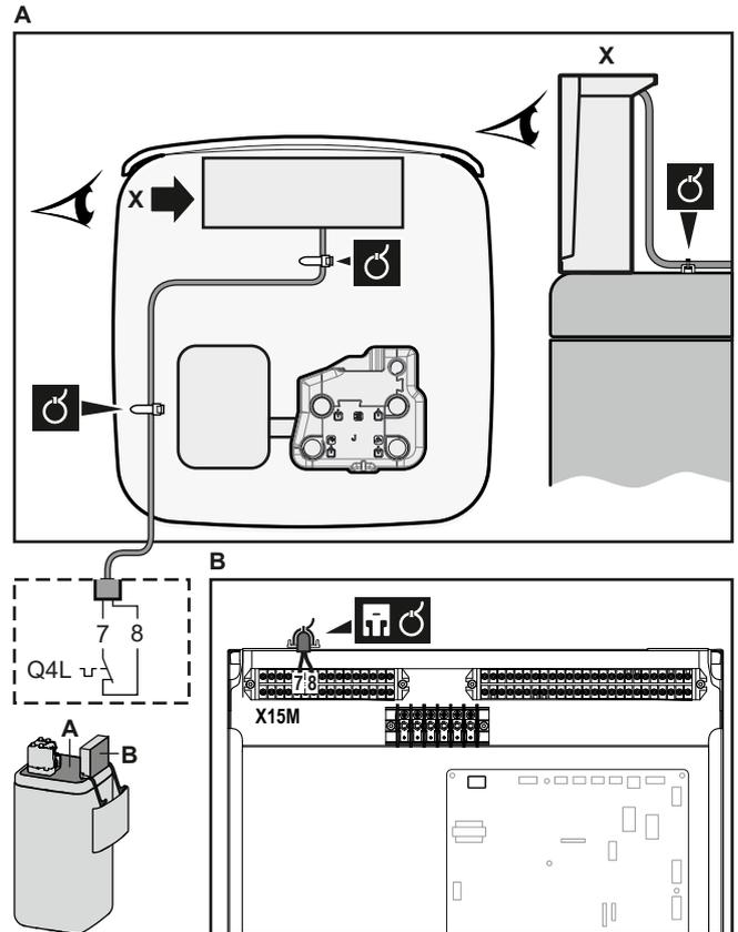
3 Befestigen Sie das Kabel mit Kabelbindern an den Kabelbinderhalterungen. Allgemeine Informationen finden Sie unter "6.3.1 Die elektrischen Leitungen an die Inneneinheiten anschließen" [▶ 22].
