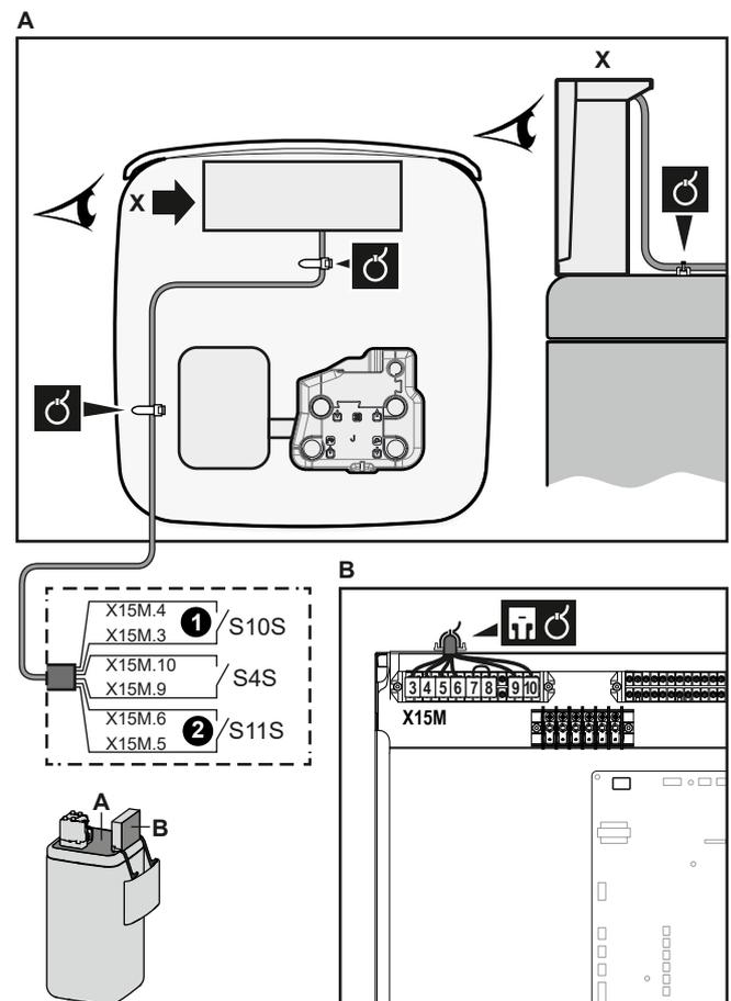
3 Fixieren Sie die Kabel mit Kabelbindern an den Kabelbinderhalterungen.
