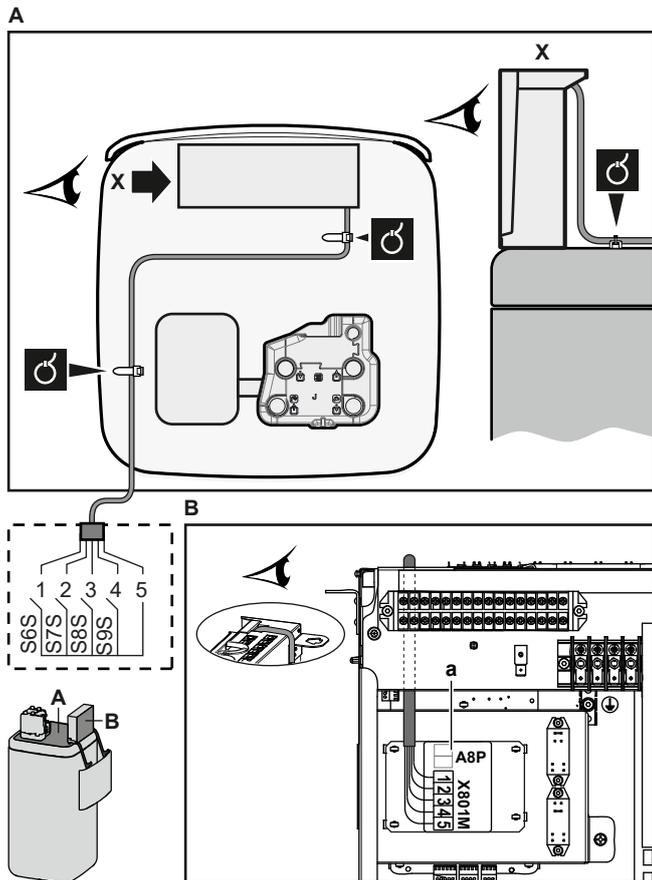
4 Befestigen Sie das Kabel mit Kabelbindern an den Kabelbinderhalterungen. Allgemeine Informationen finden Sie unter "6.3.1 Die elektrischen Leitungen an die Inneneinheiten anschließen" [▶ 22].
