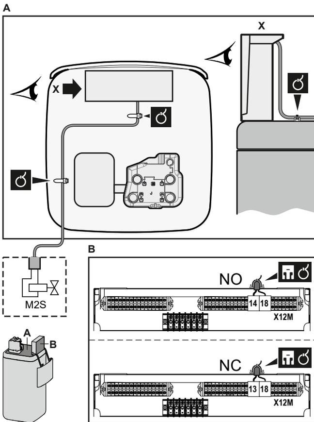
3 Befestigen Sie das Kabel mit Kabelbindern an den Kabelbinderhalterungen. Allgemeine Informationen finden Sie unter "6.3.1 Die elektrischen Leitungen an die Inneneinheiten anschließen" [▶ 22].
