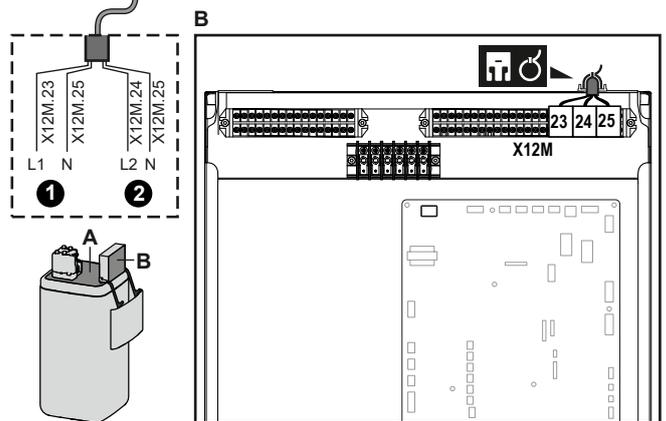
6 Befestigen Sie das Kabel mit Kabelbindern an den Kabelbinderhalterungen. Allgemeine Informationen finden Sie unter "6.3.1 Die elektrischen Leitungen an die Inneneinheiten anschließen" [p. 22].
