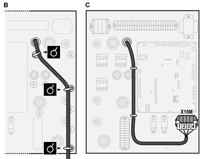
4 Fixe os cabos com as abraçadeiras nos apoios das abraçadeiras. Se necessário, junte o comprimento do cabo excessivo com uma abraçadeira.
