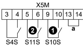
a Jumper (instalado de fábrica). Se também ligar um termostato de segurança (Q4L), substitua o jumper pelos fios do termostato de segurança.
