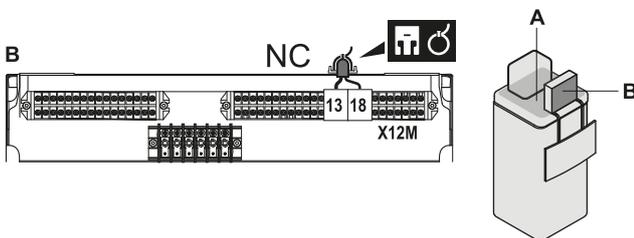
3 Fixez le câble avec les attache-câbles sur les supports d'attaches. Informations générales, voir "6.3.1 Raccordement du câblage électrique à l'unité intérieure" ▶ 22].
