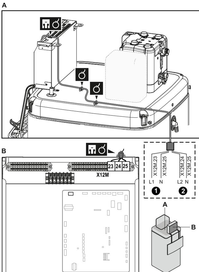
6 Fixez le câble avec les attache-câbles sur les supports d'attaches. Informations générales, voir "[6.3.1 Raccordement du câblage électrique à l'unité intérieure](#)" [p 22].
