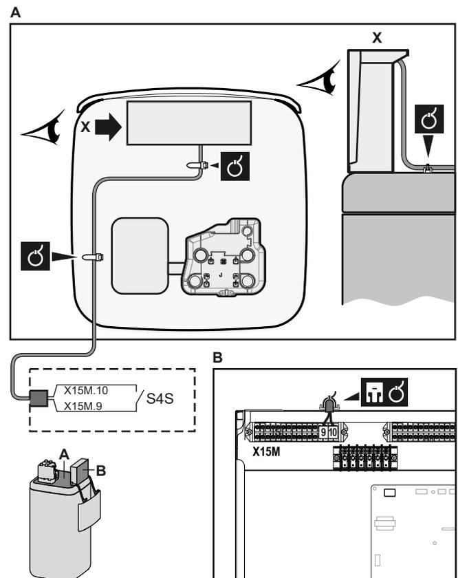
5 Conecte el cableado de alta tensión de la forma siguiente:
