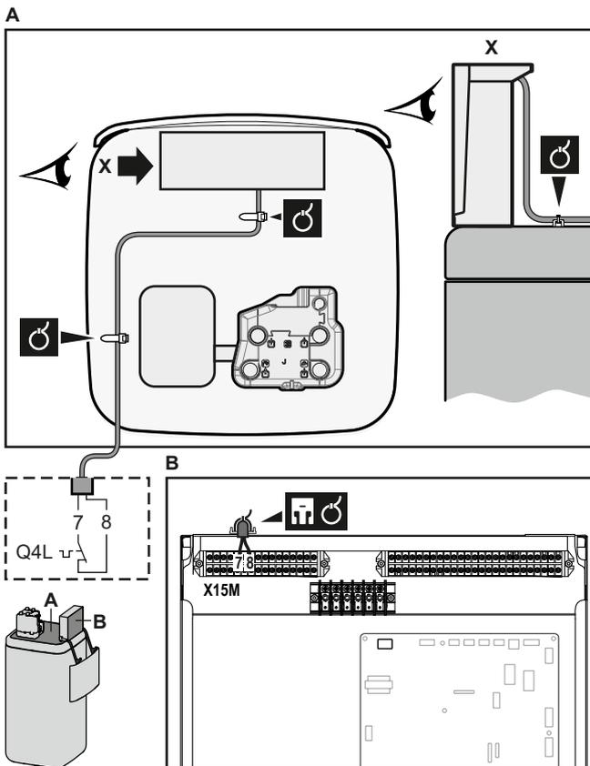
3 Fije el cable con abrazaderas a los sujetacables. Información general, véase "6.3.1 Conexión del cableado eléctrico a la unidad interior" ▶ 23].
