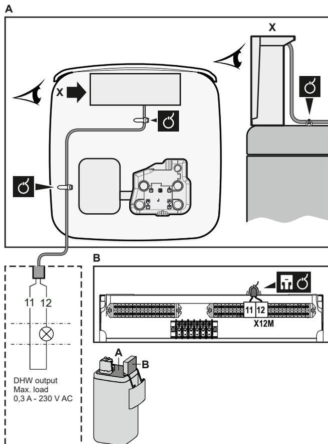
3 Fije el cable con abrazaderas a los sujetacables. Información general, véase "6.3.1 Conexión del cableado eléctrico a la unidad interior" [p. 23].
