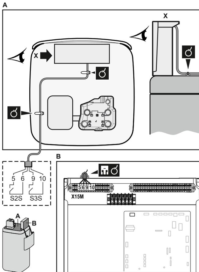
3 Befestigen Sie das Kabel mit Kabelbindern an den Kabelbinderhalterungen. Allgemeine Informationen finden Sie unter "6.3.1 Die elektrischen Leitungen an die Inneneinheiten anschließen" [▶ 23].
