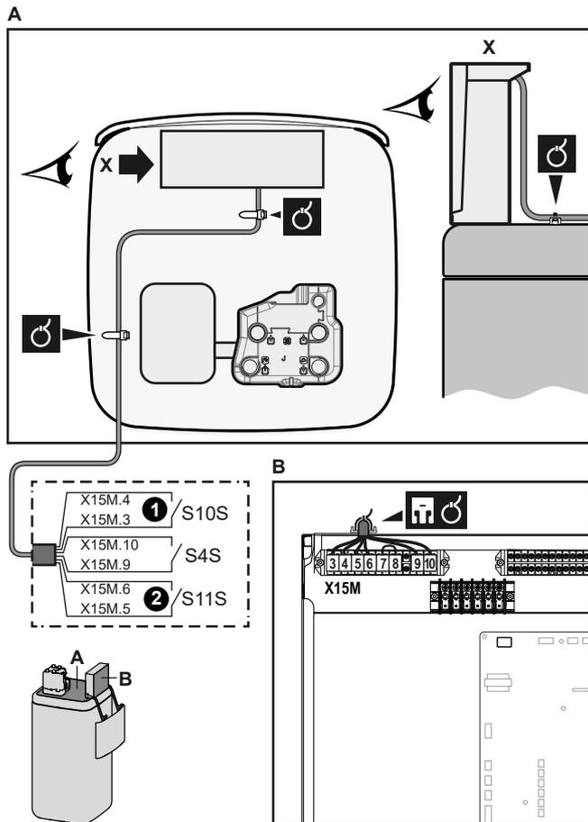
3 Fixieren Sie die Kabel mit Kabelbindern an den Kabelbinderhalterungen.
