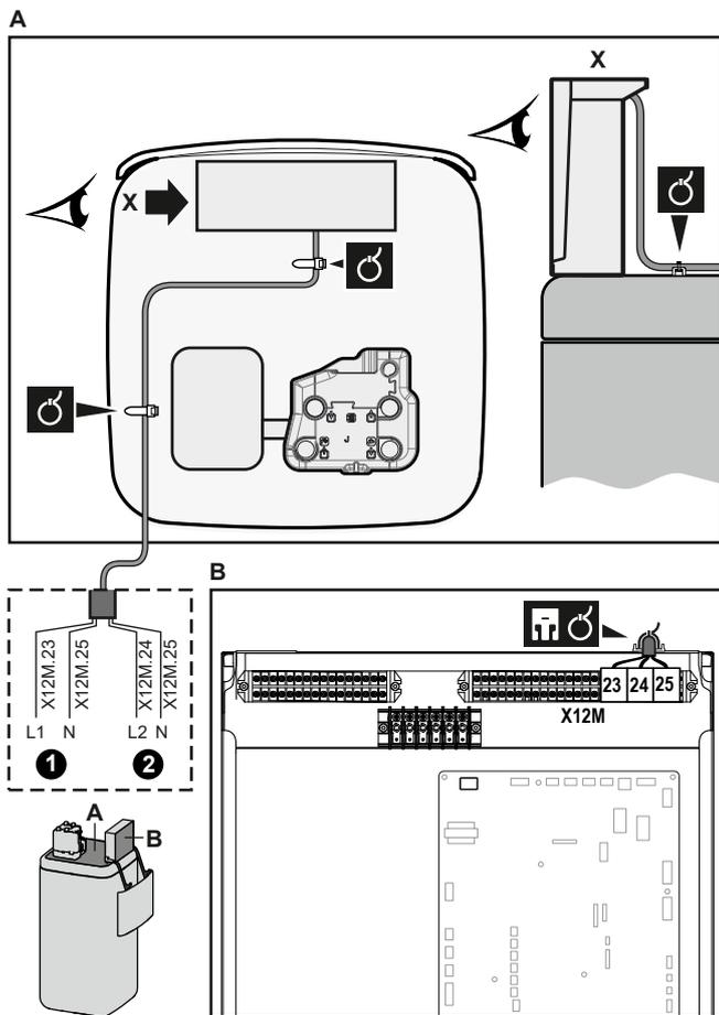
6 Befestigen Sie das Kabel mit Kabelbindern an den Kabelbinderhalterungen. Allgemeine Informationen finden Sie unter "6.3.1 Die elektrischen Leitungen an die Inneneinheiten anschließen" [▶ 23].
