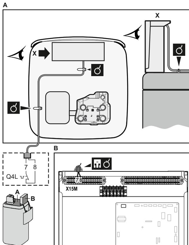
3 Befestigen Sie das Kabel mit Kabelbindern an den Kabelbinderhalterungen. Allgemeine Informationen finden Sie unter "6.3.1 Die elektrischen Leitungen an die Inneneinheiten anschließen" ▶ 23].
