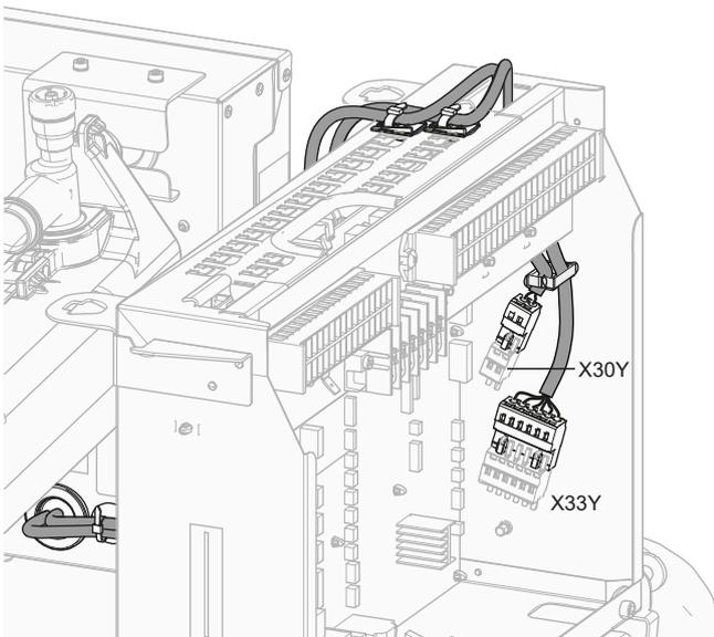
3 Befestigen Sie das Kabel mit Kabelbindern an den Kabelbinderhalterungen. Allgemeine Informationen finden Sie unter "6.3.1 Die elektrischen Leitungen an die Inneneinheiten anschließen" ▶ 23].
