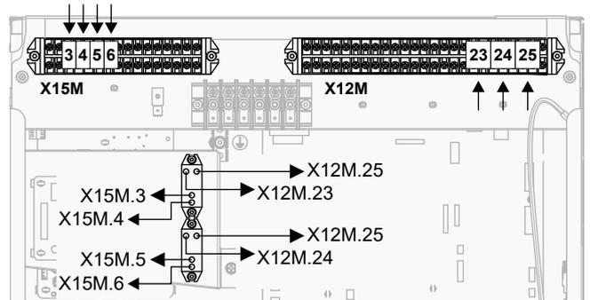
4 Schließen Sie die Niederspannungskabel wie folgt an:
