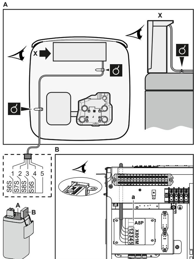
4 Befestigen Sie das Kabel mit Kabelbindern an den Kabelbinderhalterungen. Allgemeine Informationen finden Sie unter "6.3.1 Die elektrischen Leitungen an die Inneneinheiten anschließen" [▶ 23].
