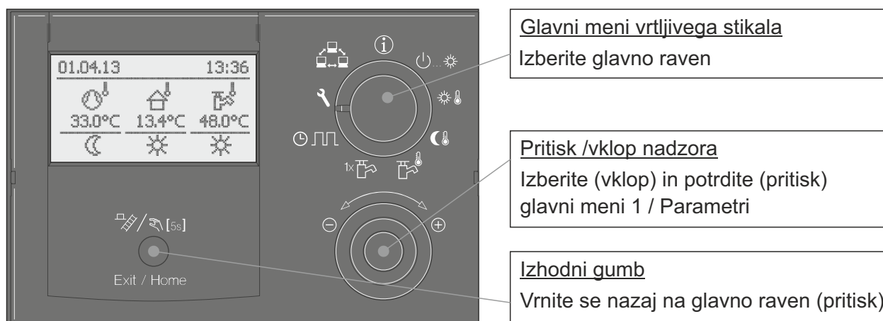
Slika 2-1 Nadzor - Kontrolna enota
