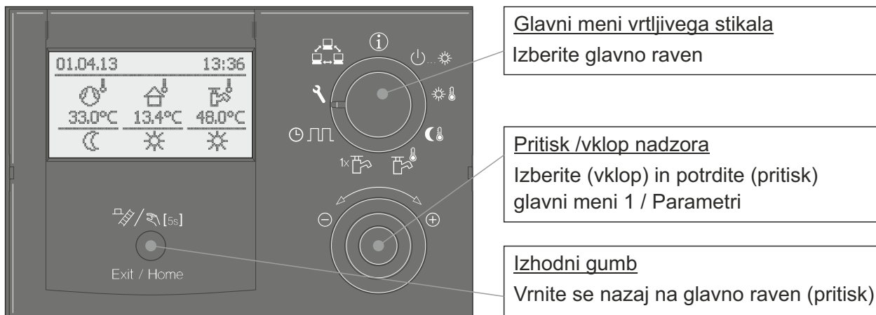
Slika 2-1 Nadzor - Kontrolna enota
