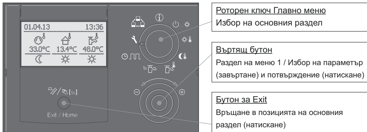
Фиг. 2-1 Регулиращо устройство - контролен панел
