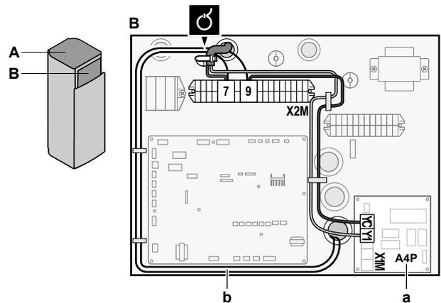
3 Fixez le câble avec les attache-câbles sur les supports d'attaches.
