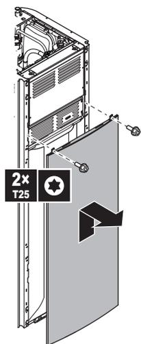
5 Si vous devez accéder aux composants haute tension, retirez le couvercle du coffret électrique haute tension.
