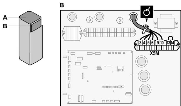
3 Fixez les câbles avec les attache-câbles sur les supports d'attaches.
