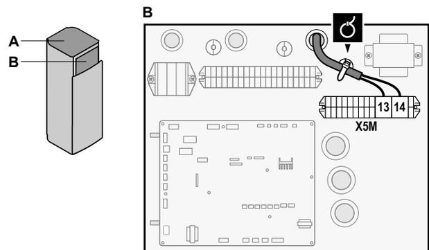
3 Fije el cable con abrazaderas a los sujetacables.
