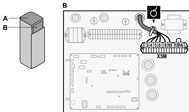
3 Fije los cables con abrazaderas a los sujetacables.
