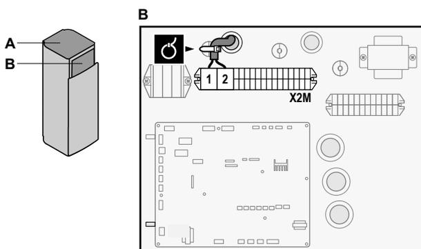
3 Fije el cable con abrazaderas a los sujetacables.
