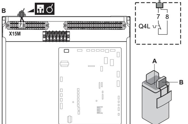
3 Fissare il cavo agli appositi supporti utilizzando le fascette. Per le informazioni generali, vedere "6.3.1 Collegamento del cablaggio elettrico all'unità interna" ► 16].
