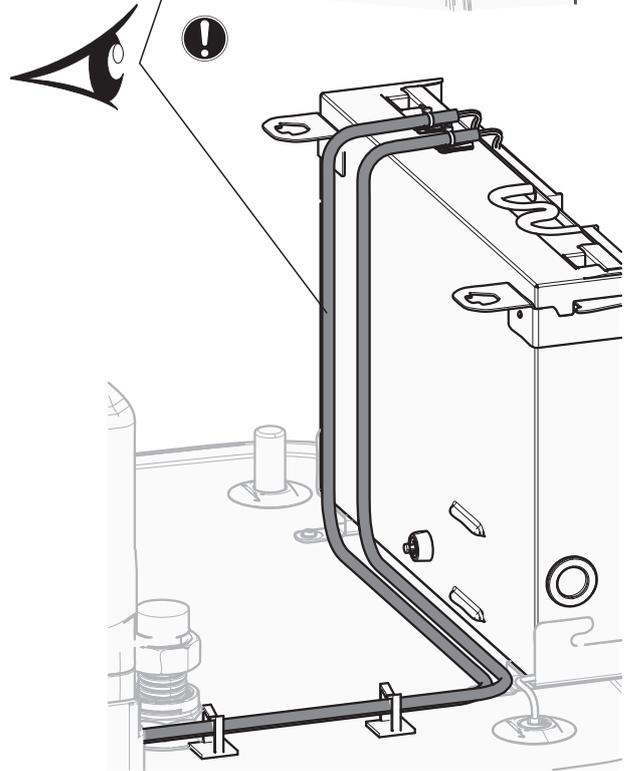
Tutti i cavi che saranno collegati al quadro elettrico di ECH<sub>2</sub>O vanno fissati con i serracavo.
