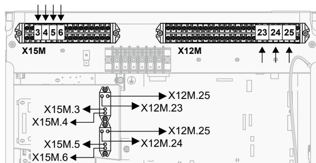
4 Collegare il cablaggio di bassa tensione nel modo seguente:
