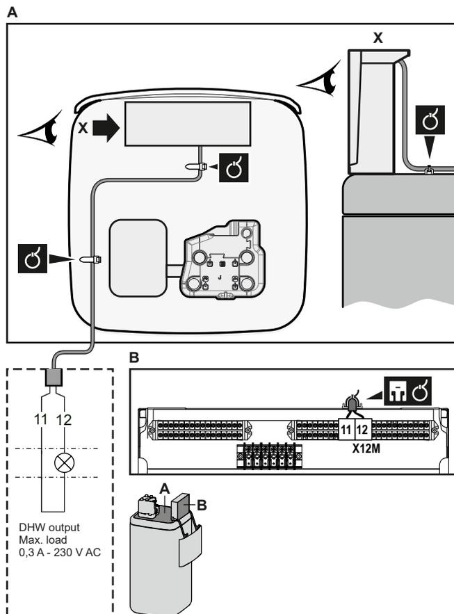
3 Fissare il cavo agli appositi supporti utilizzando le fascette. Per le informazioni generali, vedere "6.3.1 Collegamento del cablaggio elettrico all'unità interna" [p 15].
