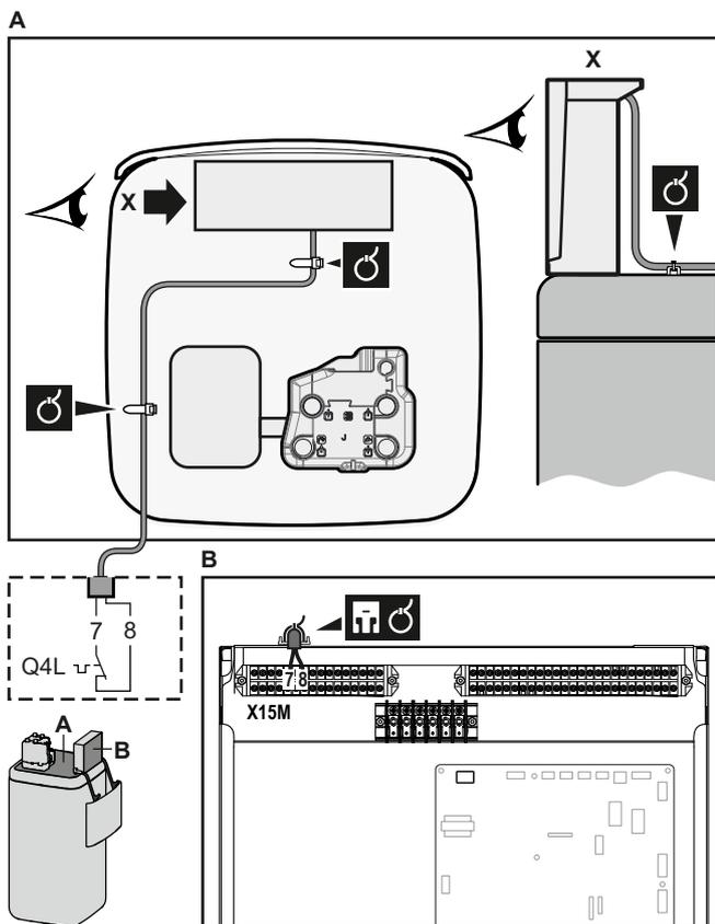
3 Fissare il cavo agli appositi supporti utilizzando le fascette. Per le informazioni generali, vedere "6.3.1 Collegamento del cablaggio elettrico all'unità interna" ► 15].
