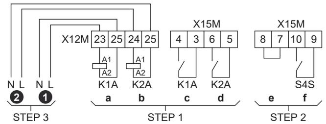
STEP 1 Installation Smart Grid-Relaissatz
