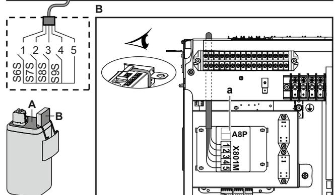
4 Befestigen Sie das Kabel mit Kabelbindern an den Kabelbinderhalterungen. Allgemeine Informationen finden Sie unter "6.3.1 Die elektrischen Leitungen an die Inneneinheiten anschließen" ▶ 16].
