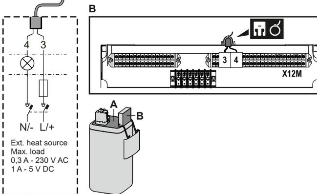
3 Befestigen Sie das Kabel mit Kabelbindern an den Kabelbinderhalterungen. Allgemeine Informationen finden Sie unter "6.3.1 Die elektrischen Leitungen an die Inneneinheiten anschließen" ▶ 16].
