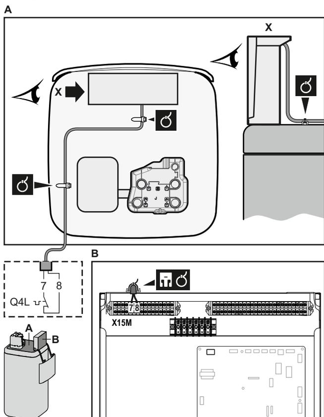
3 Befestigen Sie das Kabel mit Kabelbindern an den Kabelbinderhalterungen. Allgemeine Informationen finden Sie unter "6.3.1 Die elektrischen Leitungen an die Inneneinheiten anschließen" ▶ 16].
