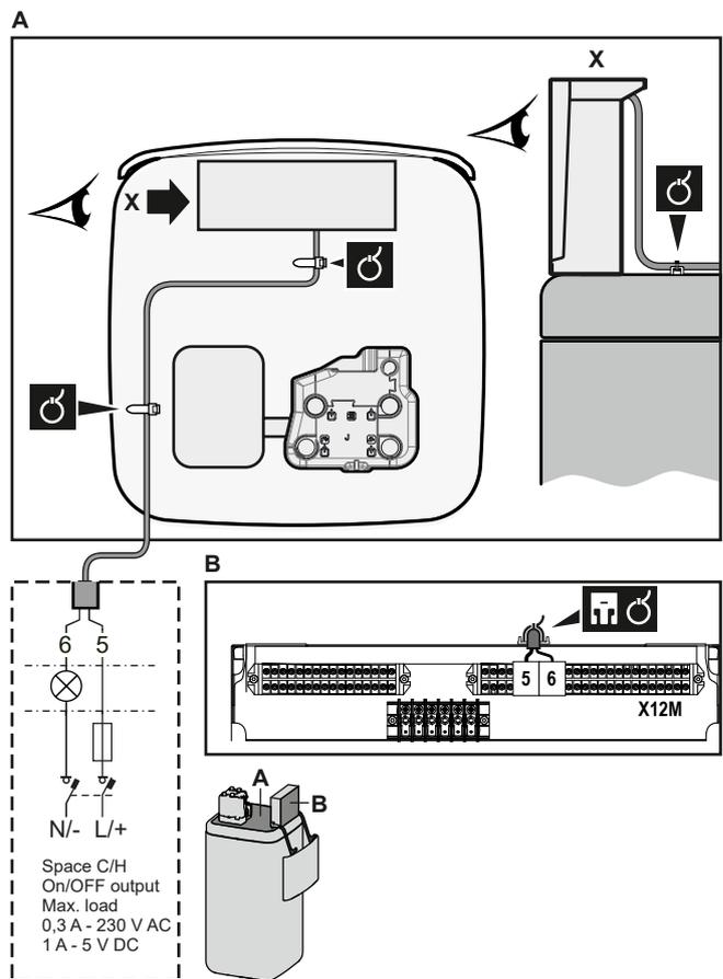
3 Befestigen Sie das Kabel mit Kabelbindern an den Kabelbinderhalterungen. Allgemeine Informationen finden Sie unter "6.3.1 Die elektrischen Leitungen an die Inneneinheiten anschließen" [▶ 16].
