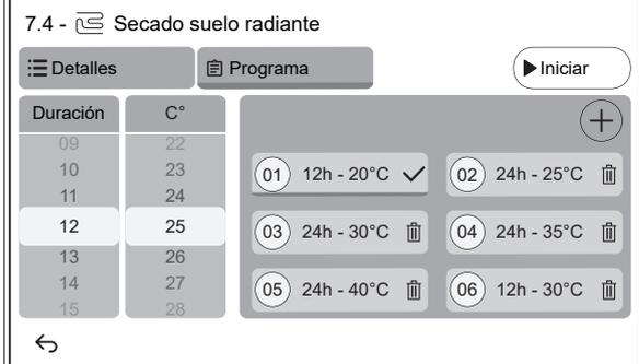
Cada paso de programa contiene el número de secuencia, la duración y la temperatura del agua de impulsión deseada.
