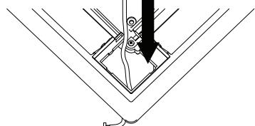
Provucite kabel kroz otvor, umetnite pokrov na mjesto i pričvrstite ga vijkom.
