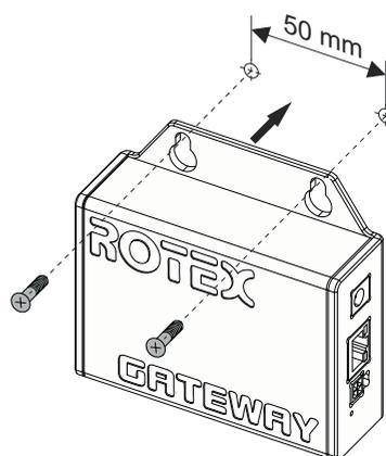
Figura 2: Montaje en la pared
