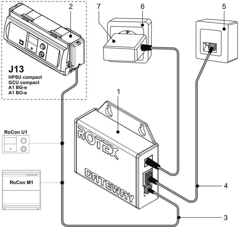
Figura 3: esquema de conexiones RoCon G1
